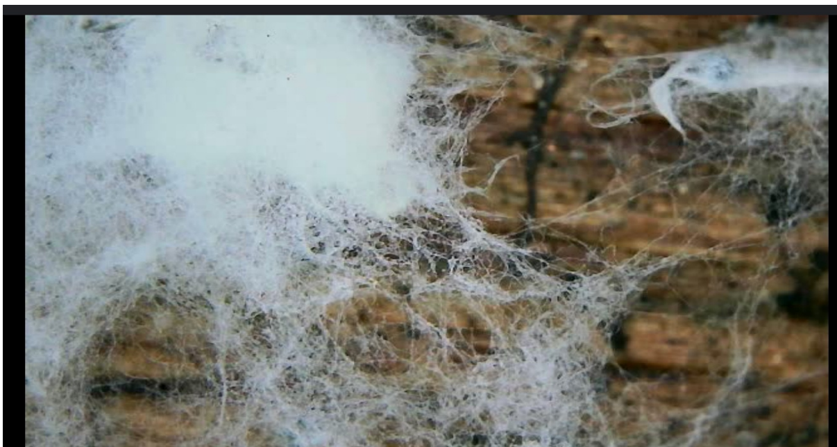
Fot. 10 Grzybnia Coniophora puteana pod mikroskopem w badanym budynku. fot. E. Wilbik 2025r.
