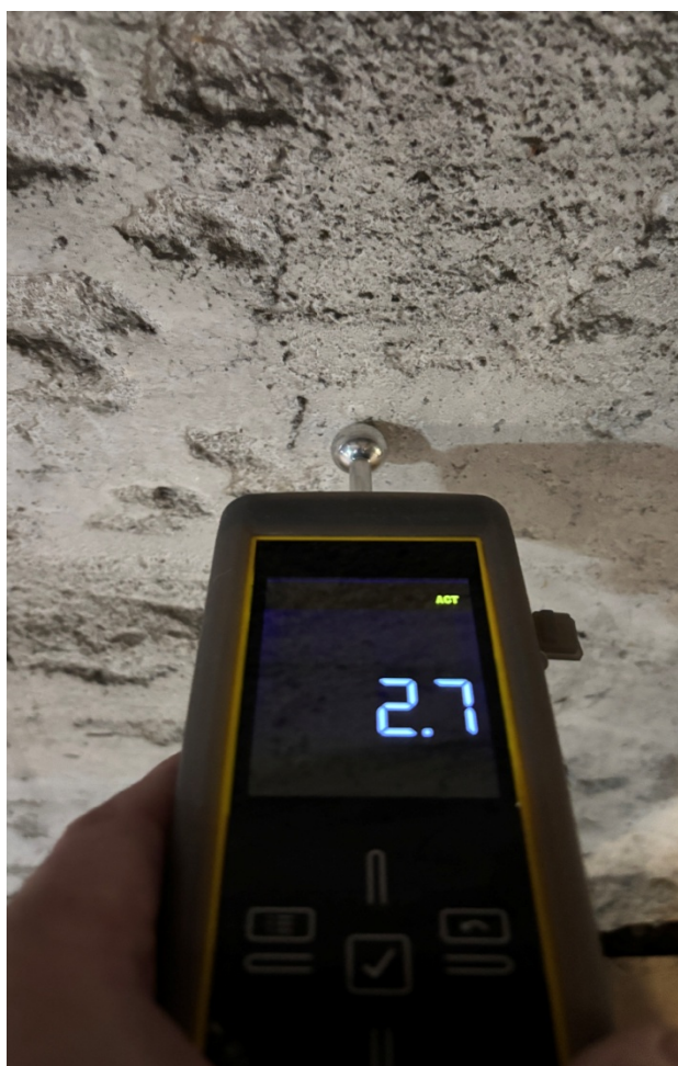
Pomiar wilgotności przegrody budowlanej Miernik wilgotności TROTEC T660 foto P Pakuła Maj 2025 - Przegroda sucha pomiar w DIGITS 2,7 -przegroda sucha do 40 jednostek porównawczych
